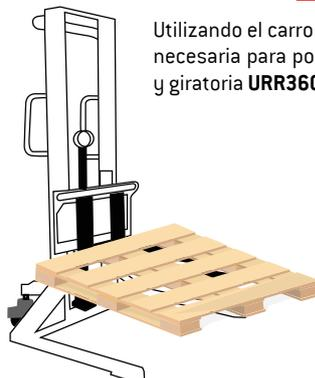
Ubique la mesa **URR360-2000** a la altura necesaria para que el operador realice las cargas y así evitar lesiones lumbares. Esta permite hasta una altura máxima de 705 mm.
